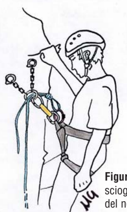
Figura 3: collegamento dell'asola all'anello di servizio dell'imbrago mediante moschettone a ghiera
